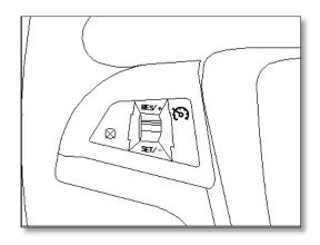
克鲁兹系列的原厂开关由 4 个按键组成,分别为可上下拨动的 RES/+和 SET/-键; \(\tilde{Q}\)键; \(\tilde{Q}\)N/OFF键。对应于悠途定速巡航系统,四个按键通过组合操作可完成悠途的全部功能。
