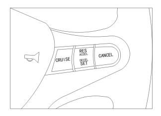
本田系列的原厂开关由 4 个按键组成,分别为可按动的 ACCEL/RES 和 DECEL/SET 键; CANCEL键; ONOFF 键。对应于悠途定速巡航系统,四个按键通过组合操作可完成悠途的定速、油门加速、经济模式功能的操作。
